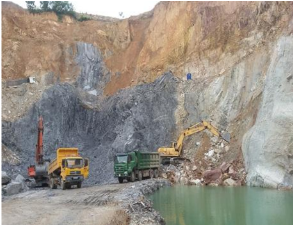
Ảnh 3.1. Đới vỏ nhàu dập vỡ, thể nằm dốc đứng chứa quặng đồng mỏ Góc Sáu
